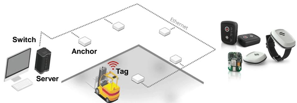
Die Hardware zur Echtzeitlokalisierung (RTLS) besteht aus
